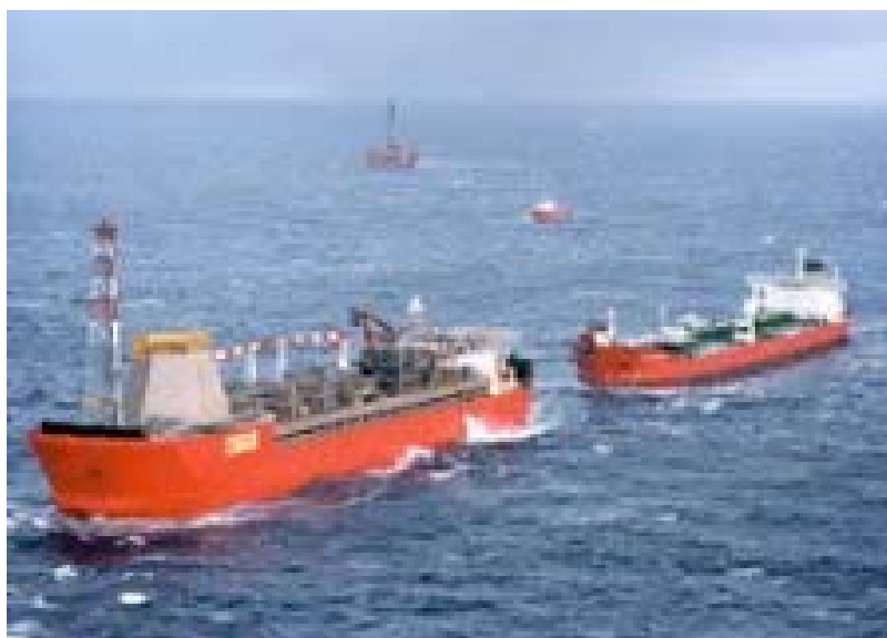
Figura 3.6.1-a. Exemplo de operação de transferência de óleo in tandem . Fonte: UKOOA - United Kingdom Offshore Operators Association
