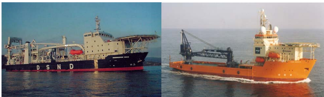
Figura 3.4.1-b. Fotos das embarcações DSND Kommandor 3000 e Torsa Perseus a serem utilizados nos trabalhos de instalação das linhas de fluxo.
