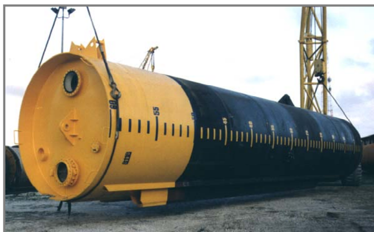
Figura 3.4.3-a. Âncora de sucção a ser utilizada na ancoragem do FPSO P-43
